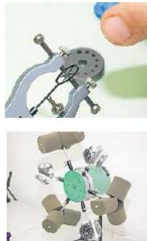
Einblicke in die Herstellung einer Damasko-Uhr: Automatische Prozesse, Handarbeit und elektronische Überwachung sichern die Qualität der Einzelkomponenten (obere Reihe). Uhrmacher setzen die winzigen Bauteile zu ein bis zwei Armbanduhren täglich zusammen (links und mittlere Reihe oben). Rotierende Testgeräte setzen die fertigen Uhren in einem Praxistest aus (Mitte unten). Rechts zeigt Christoph Damasko mit dem Messer die Robustheit der Gehäuse.
