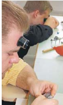
Einblicke in die Herstellung einer Damasko-Uhr: Automatische Prozesse, Handarbeit und elektronische Überwachung sichern die Qualität der Einzelkomponenten (obere Reihe). Uhrmacher setzen die winzigen Bauteile zu ein bis zwei Armbanduhren täglich zusammen (links und mittlere Reihe oben). Rotierende Testgeräte setzen die fertigen Uhren in einem Praxistest aus (Mitte unten). Rechts zeigt Christoph Damasko mit dem Messer die Robustheit der Gehäuse.
