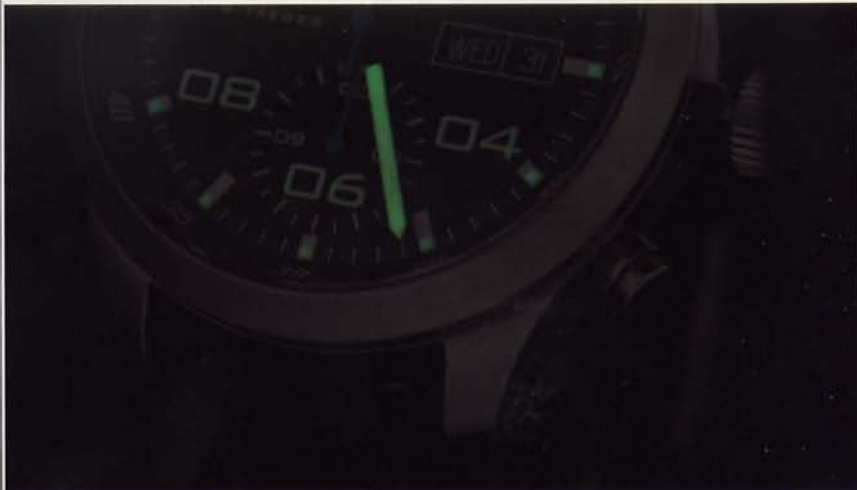
NBY: Hier hat einer ganz tief in den Leuchtmass-»Topf« gegriffen und kräftig Zeiger, Stundenindices und Ziffern mit Superluminova belegt. Noch nach einigen Stunden lässt sich die Uhrzeit ablesen.
