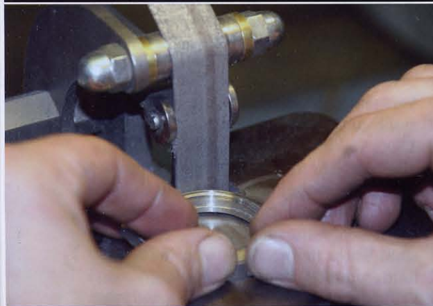
Vor dem Härten schleift die Bandschleifmaschine die Gehäuseaußenform einer Sinn-Uhr.
