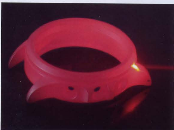
Temperaturmessung an einem glühenden Gehäuse mittels Abtastung durch einen Laserstrahl.
